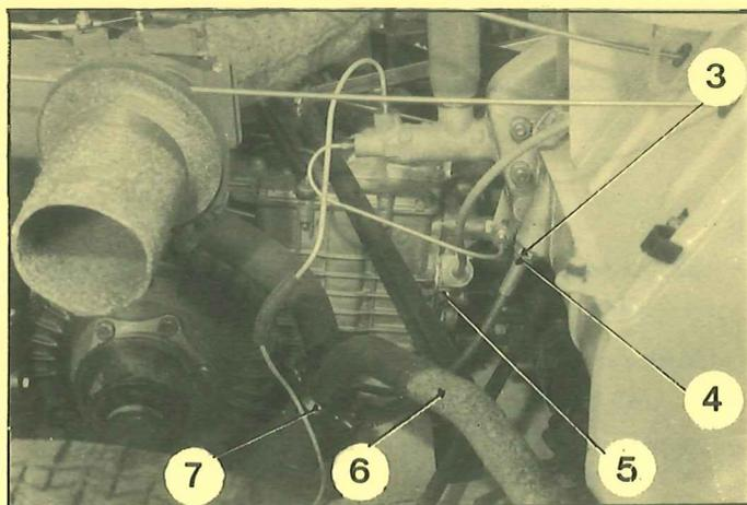
Engager l'extrémité du câble dans la caisse et mettre en place l'embout dans la chape de pédale.
