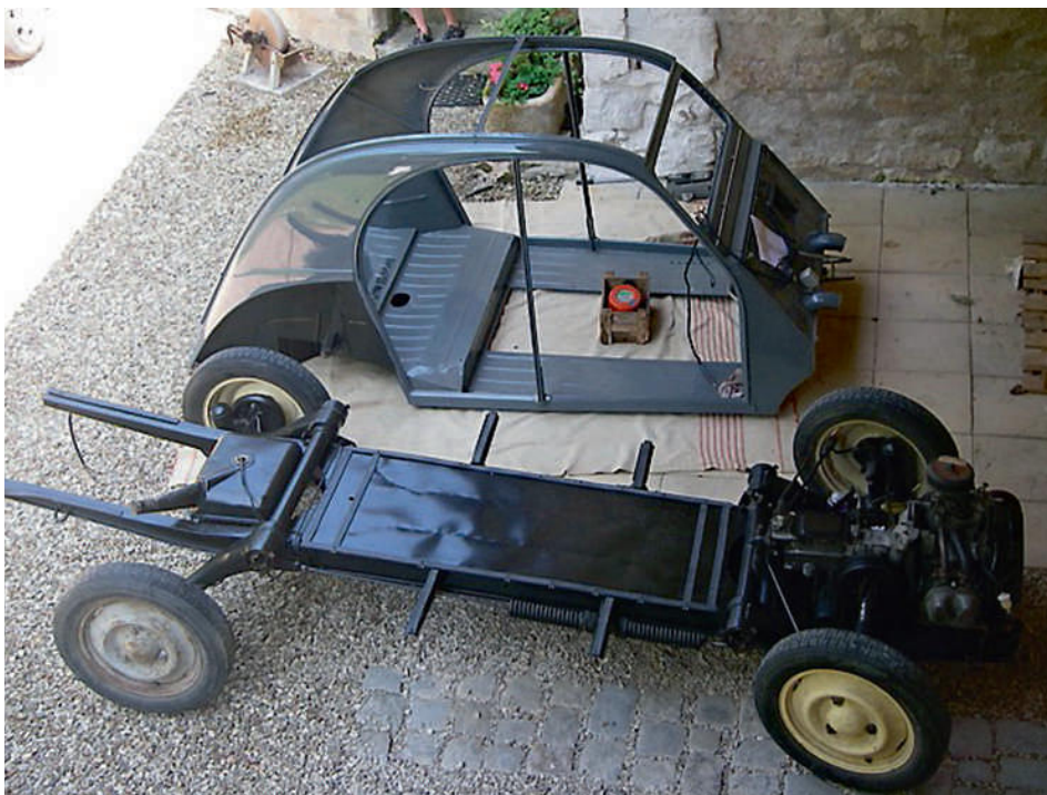
Châssis et caisse sortent de peinture. Le travail est quasiment terminé.
