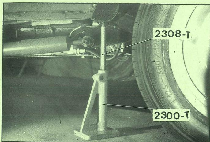
7. Régler les hauteurs arrière en vissant ou dévissant les tirants arrière. Si la correction est importante, les hauteurs avant seront hors tolérance. Agir à nouveau sur les tirants avant pour terminer le réglage. Utiliser l'embout 3455-T et la clé 3456-T,
