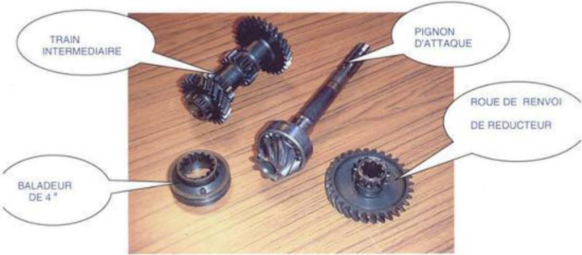
Fig C2 :Ensemble de l'arbre du pignon d'attaque
