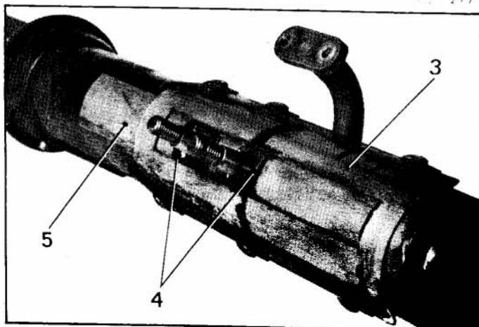
4. Déposer la glissière ( 3 ), dégager le cache mobile ( 5 ) et les dés ( 4 ) de guidage des rotules.
