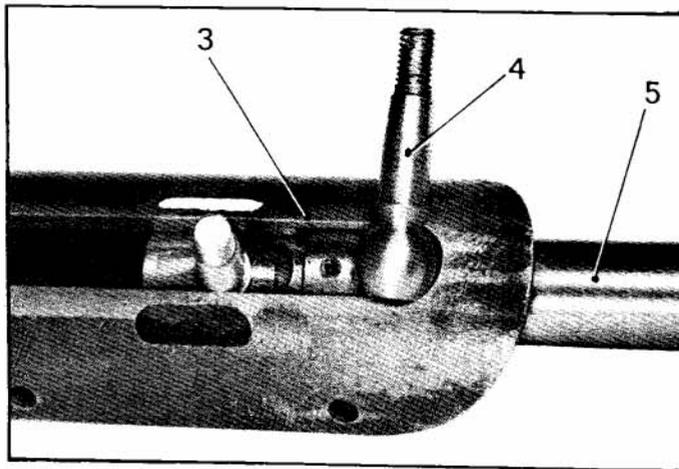
9. Placer le tube de crémaillère (5) muni de ses rotules dans la position indiquée ci-contre, par rapport au guide (3) des rotules. Repousser le siège (9) à l'aide de la rotule (4) pour dégager celle-ci du tube de crémaillère.
