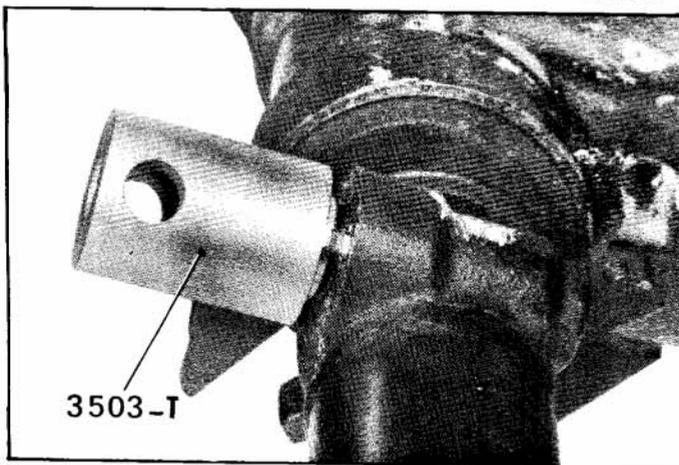
7. Chasser le coussinet ou la douille à aiguilles du pignon de crémaillère, à l'aide d'un mandrin épaulé A passant par l'intérieur du boîtier.
