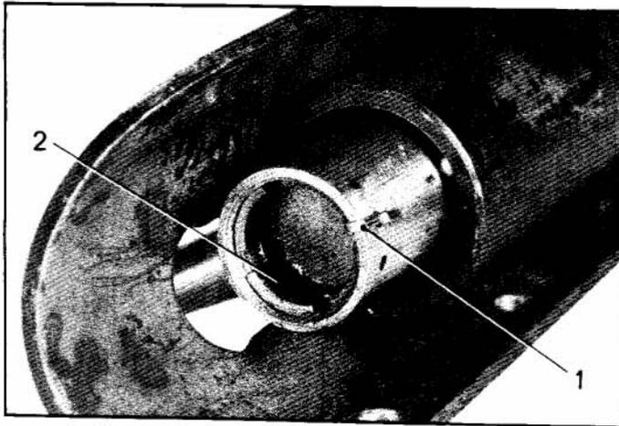
8. Déposer la goupille (1) et dévisser l'écrou (2) de butée de rotule (clé MR. 630-16/2).
