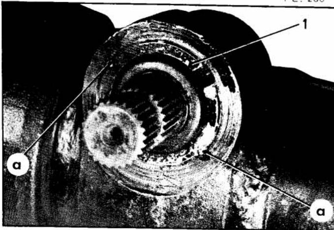
Déposer l'écrou (1) de blocage du pignon de crémaillère. Le défreiner soigneusement. Pour cela : à l'aide d'un foret de  $\phi = 4$  mm, percer les coups de pointeau « a » de freinage de l'écrou puis déposer l'écrou (clé 3503-T).
